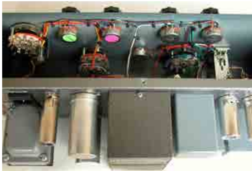
L'interno di EQP1A accoglie i potenziometri e gli switch
