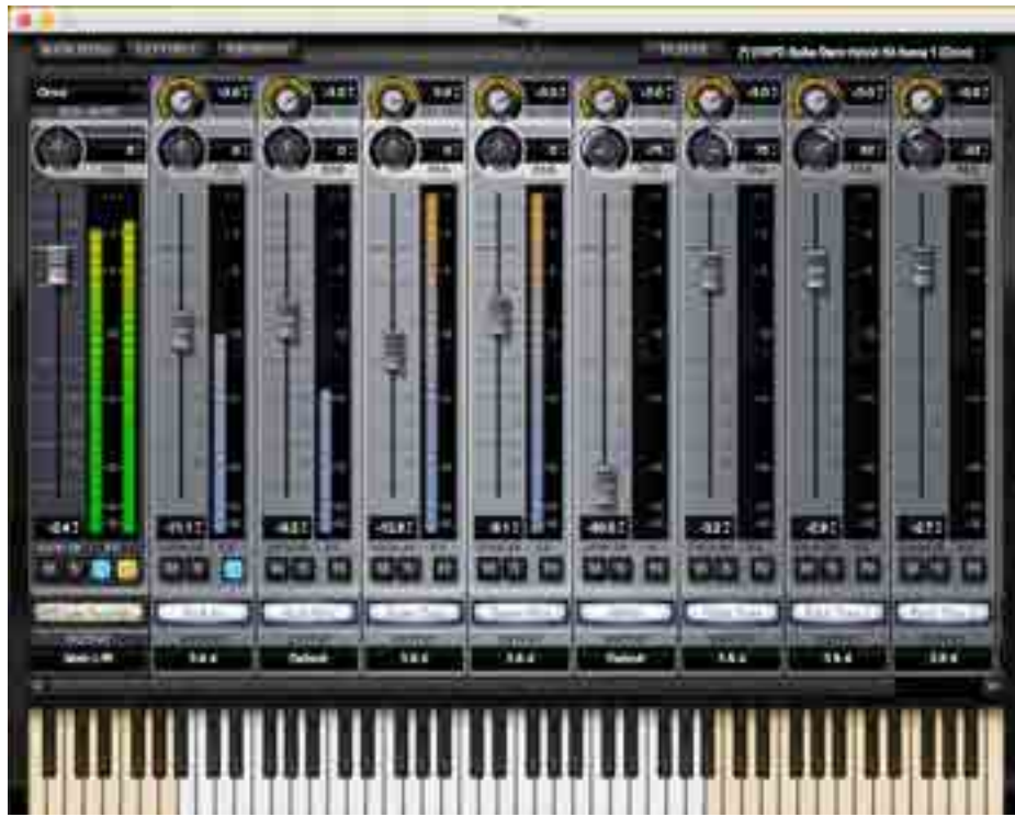
Mixer View , dove è possibile controllare le uscite separate, attivare la sezione effetti
