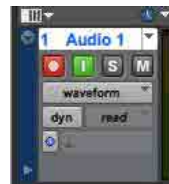
01 . il pulsante contrassegnato con la lettera I attiva/disattiva il comando di Input Monitoring
