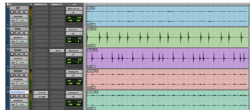
Figura 2. Si nota la mandata al Bus 5 dalla traccia del rullante che andrà in chiave al gate della room
