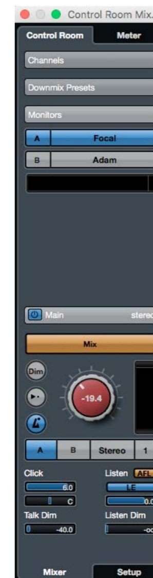
Figura 3. Finestra Control Room Mixer nella quale è possibile notare i tasti A e B relativi ai 2 monitor che nel nostro caso sono stati rinominati in base alla marca
