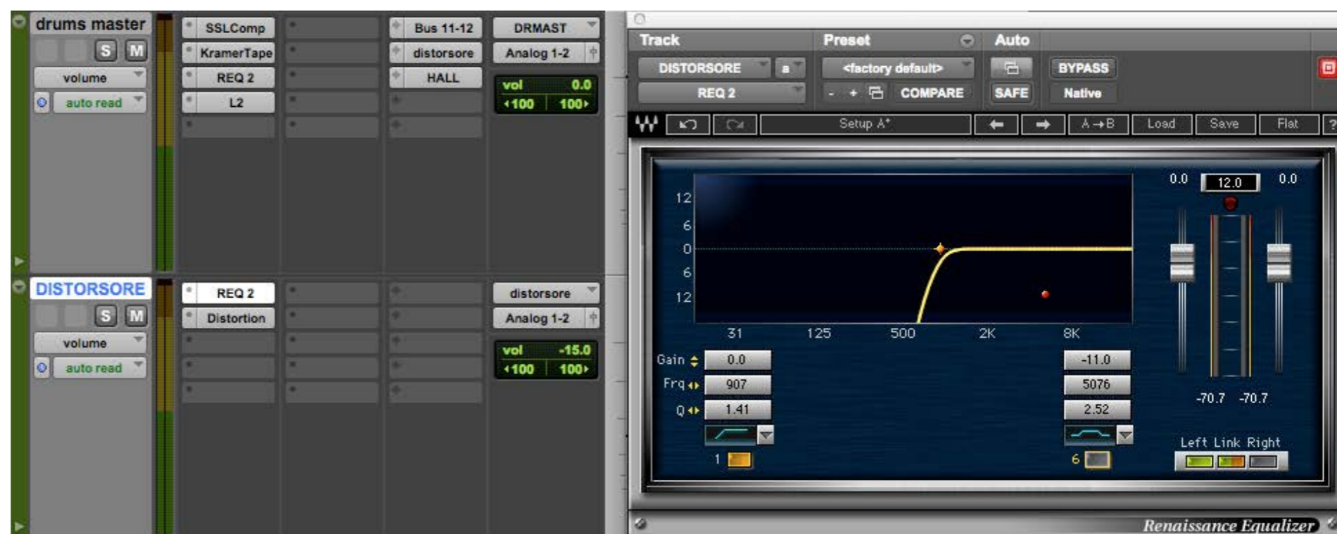
Figura 4. È bene mettere un filtro passa alto prima del distorsore per evitare di processare anche le frequenze basse e medio basse
