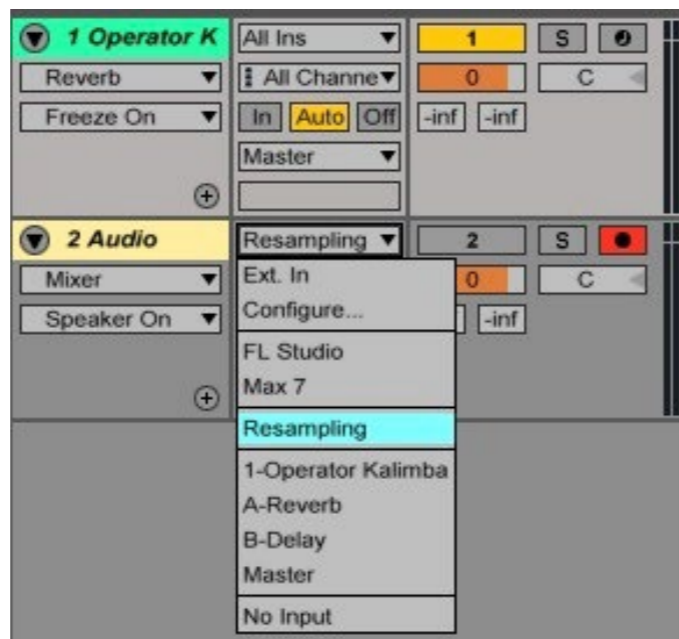
Figura 3. Il comando di resampling da selezionare nell'ingresso della nuova traccia audio creata
