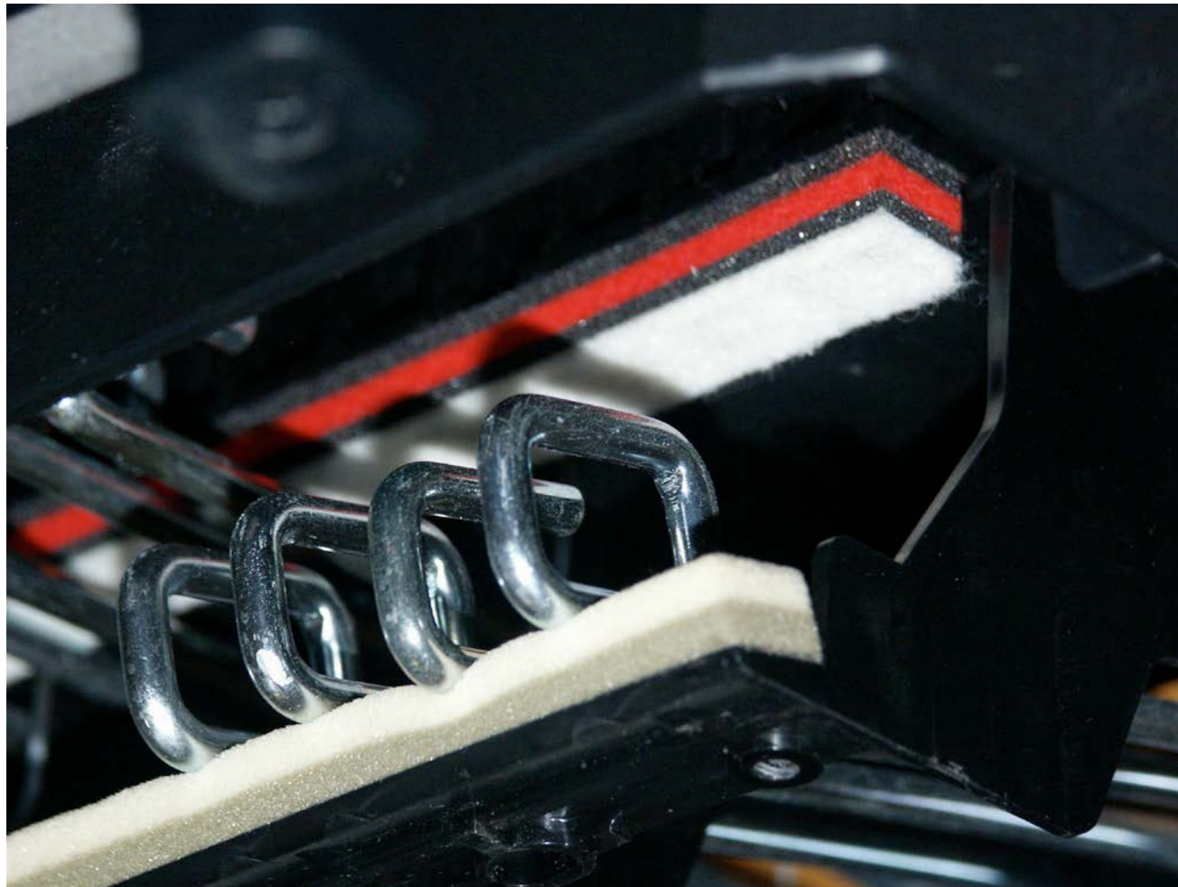
Un primo piano dei martelletti montati sulla meccanica Graded Hammer Standard
